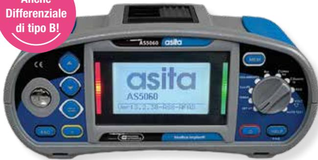
Strumento multifunzione per verifiche su impianti elettrici secondo quanto previsto dalla norma CEI 64-8 e dal D.M. 37/08. Ideale per completare velocemente le dichiarazioni di conformità con i risultati ottenuti.
