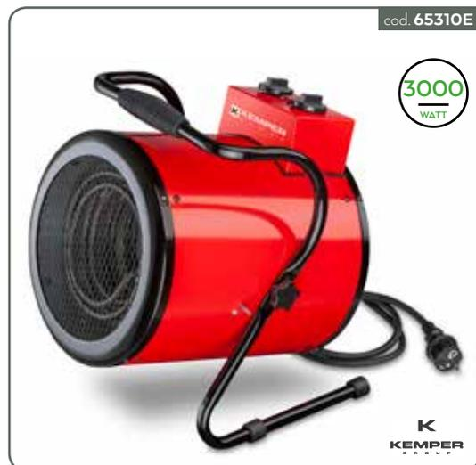
3 livelli di potenza: 30-1500-3000W. Con maniglia integrata, stand, termostato ambiente regolabile (1500W+1500W) e termostato di sicurezza antisurriscaldamento. Protezione: IP44. Elemento riscaldante in acciaio inox. Portata d'aria: 400 m<sup>3</sup>/h. Potere calorifero: 2580Kcal/h; 10200Btu. Motore con protezione termica. In acciaio verniciato. Frequenza: 50Hz. Tensione: 220V. Dim. imballo: 38x35x38 cm. Peso netto/lordo: 5,9/6,6 kg.
