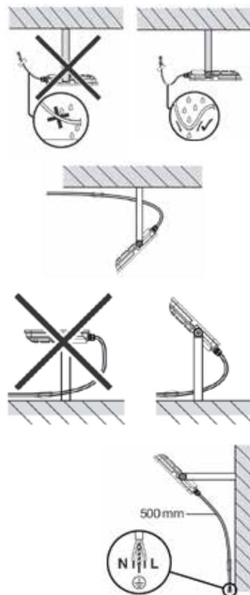
Per un cablaggio corretto sono necessarie dei raccordi stagni. (NON INCLUSE).
