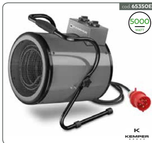
In acciaio verniciato. 3 livelli di potenza (ventilazione estiva (30/2500/5000 W). Livello di protezione IP 44. Resistenza ad alta efficienza in acciaio Inox. Ventilatore elettrico incorporato con portata d'aria 411 m<sup>3</sup>/h. Maniglia per il trasporto. Termostato ambiente regolabile. Motore con protezione termica. Termostato di sicurezza anti surriscaldamento. 335x335x415 mm. Peso 7,6 kg.
